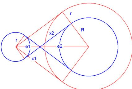
Der halbe Schnittwinkel zwischen den sich schneidenden Tangenten werde mit  $\alpha$  bezeichnet.
