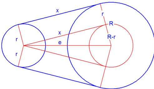
Mithilfe der Beziehung  $\sin(\alpha) = (R - r)/e$  kann aus den gegebenen Größen  $r$ ,  $R$  und  $e$  der Winkel  $\alpha$  bestimmt werden. Die Gesamtlänge  $u$  der Bahn ergibt sich aus den Längen der Bögen auf den beiden Kreisen sowie den beiden geraden Strecken der Länge  $x$ . Die Länge  $x$  kann mithilfe des Satzes von Pythagoras oder mithilfe des Kosinus von  $\alpha$  berechnet werden:  $\cos(\alpha) = x/e$ :
